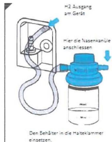
Stecken Sie den Schlauch, der am H2 Ausgang des Gerätes herauskommt an den Behälter!
